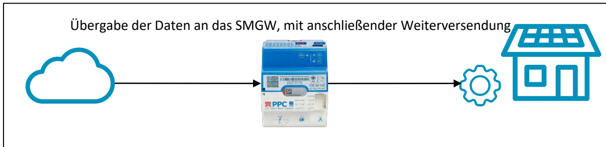
Abbildung 126: Datenweiterleitung über das SMGW an das EMS.
