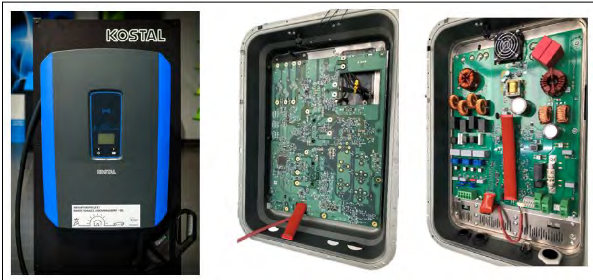
Abbildung 21: Fertiges EVSE-Gehäuse und interne Ansichten der Leistungselektronik
