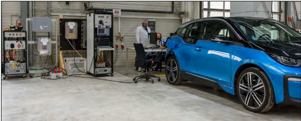
Abbildung 25: Funktionstestplatz für BDL-Wallbox, hier mit BiDi-fähigem BMW i3
