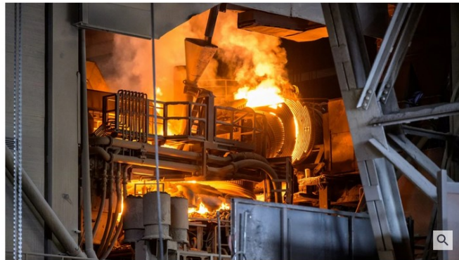
Ein Elektrolichtbogenofen auf dem Gelände eines Stahlwerks. Foto: Jonas Walzberg/dpa/Archivbild (Foto: dpa)
