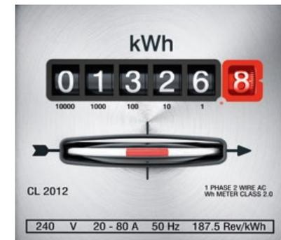
*Das Messprinzip basiert auf dem Induktionsgesetz, wobei ein Spulenpaar, eine drehbare Aluminiumscheibe, ein mechanisches Zählwerk und ein Bremsmagnet die wichtigsten Komponenten der einphasigen Messung umfassen: Die Anordnung der Spulen sowie das grundsätzliche Messkonzept haben zur Folge, dass es sich um eine Messung der reinen Wirkenergie handelt.*
